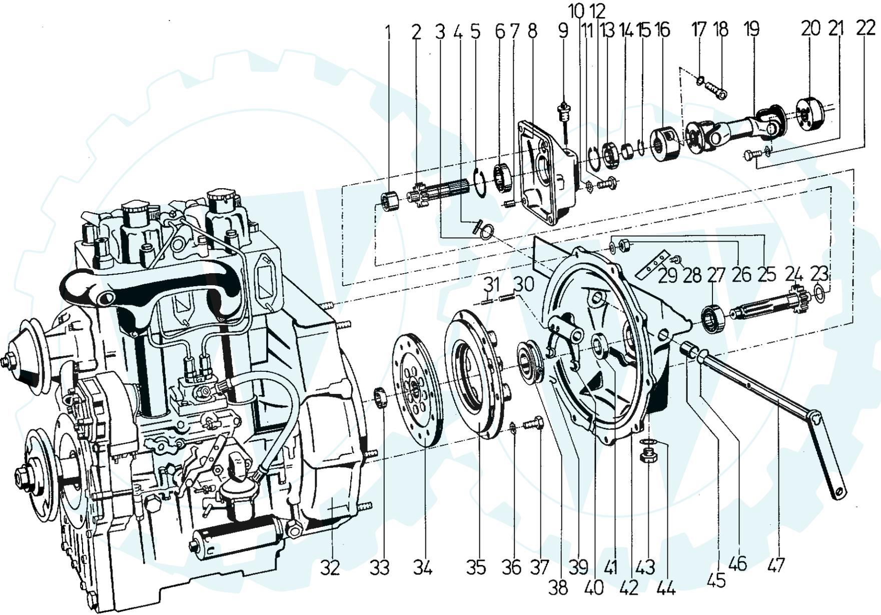
**Tafel 1397 Motor, Kupplung, Umkehrgetriebe (Diesel-Ausführung)**
